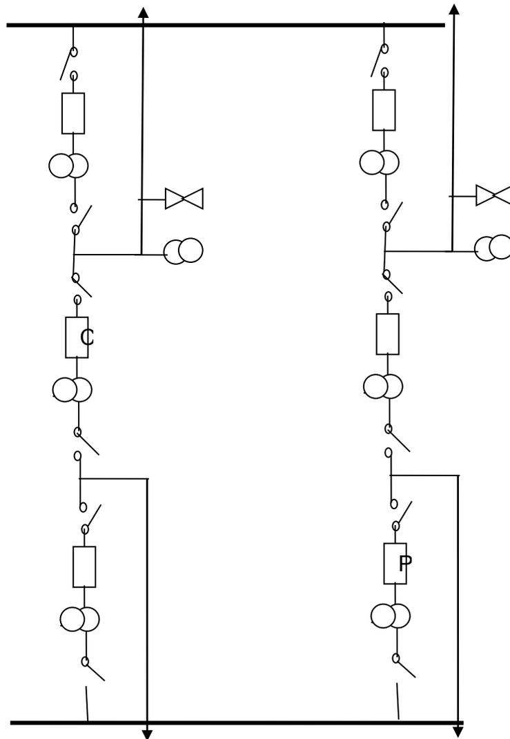
Gambar 2-7. Single line diagram gardu induk satu setengah busbar
