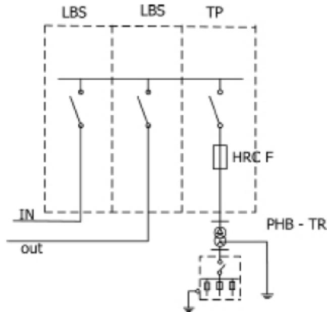
Gambar 4-7. Konfigurasi  $\pi$  section Gardu Pelanggan Umum.
