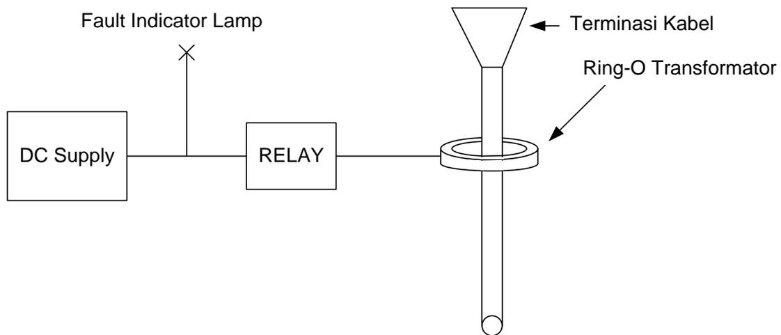
Pada Key Point dengan pemasangan pada tiang, fault indicator terpasang pada tiang untuk gardu tiang
