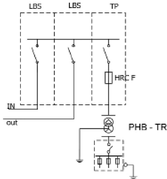
Gambar 4-2. Bagan satu garis konfigurasi  $\pi$  section Gardu Portal.
