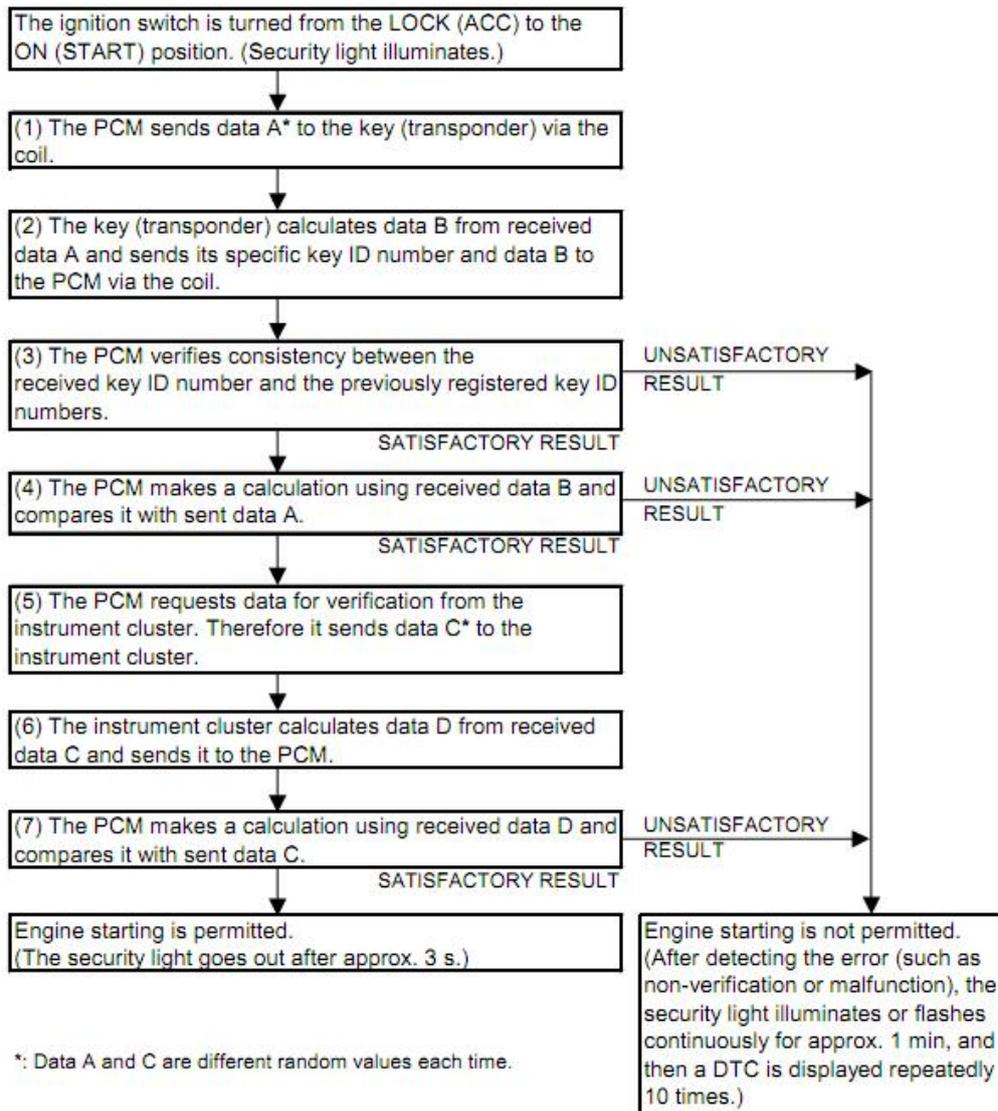
Gambar 9.33 Flowchart verifikasi nomer ID pada D-PATS (Mazda2)
