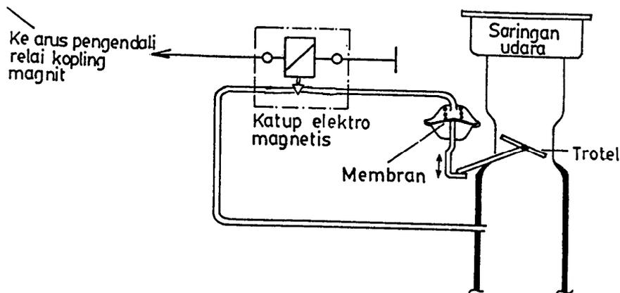
Gambar 7. 47. Skema idle up sistem AC
