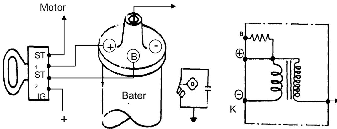
Gambar 4.37. Tahanan balast di dalam coil
