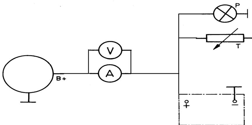
Gambar 5 41. Rangkaian voltmeter dan ampermeter
