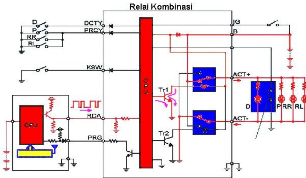
Gambar 8. 13. Operasi tutup dengan remote
