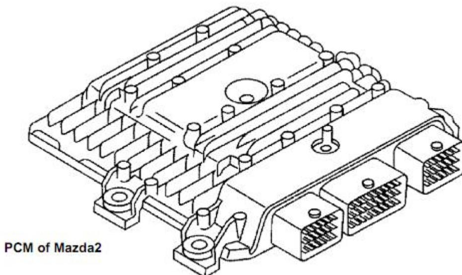
Gambar 9.9 Powertrain Modul (PCM)
