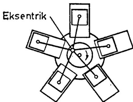
Agar gerakan torak pada silinder dapat menuju ke arah diameter luar kompresor, maka dipasang sebuah eksentrik pada poros kompresor.
