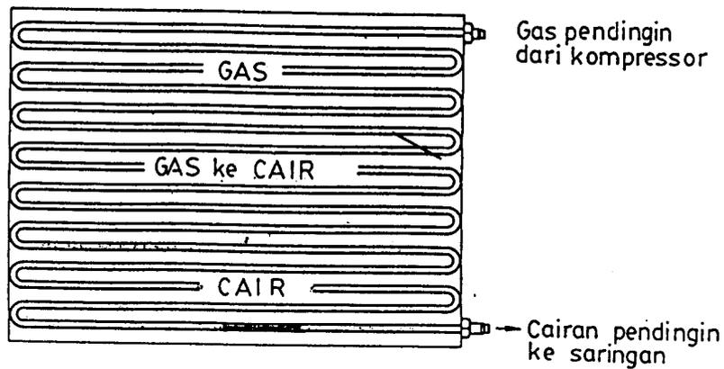
Gambar 7. 25. Bagan zat pendingin kondensor sistem AC
