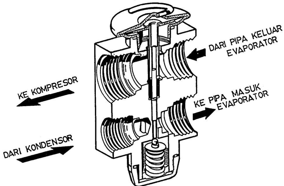
Gambar 7. 36. Katup ekspansi model blok
