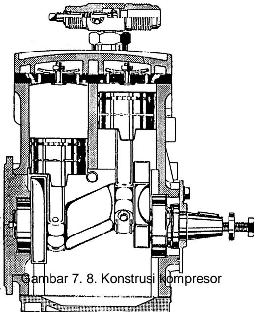
Gambar 7. 8. Konstruksi kompresor
