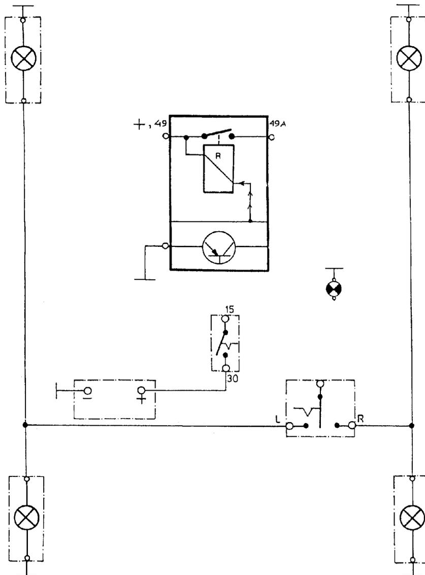
Gambar 3. 33. Skema lampu belok dengan pengedip transistor
