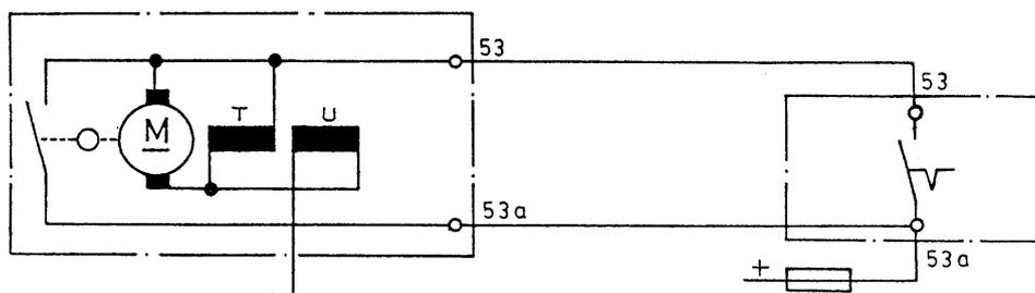
Gambar 9.24. Motor dengan magnet listrik
