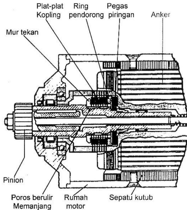
Gambar 6. 32. Konstruksi kopling plat ganda stater batang dorong pinion model "T" (Bosch)
