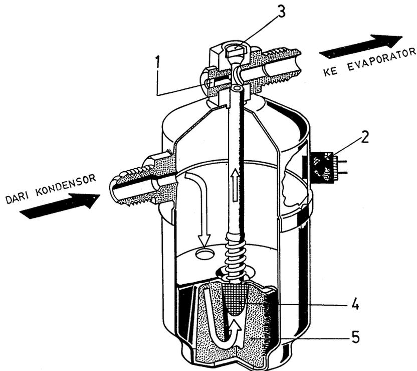
Gambar 7. 30. Aliran zat pendingin pada filter
