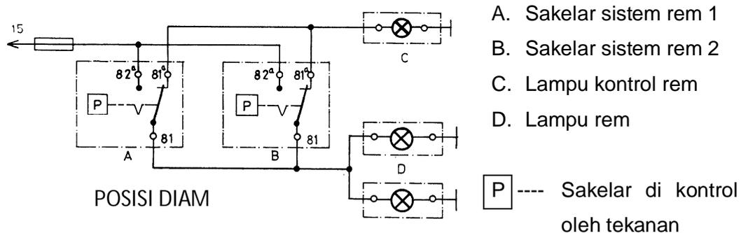
Gambar 3. 55. Skema kontrol rem posisi diam
