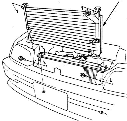
Gambar 7. 10. kondensor yang akan dipasang di depan kendaraan
