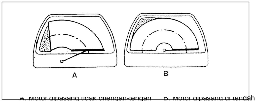
Gambar 3. 20. Posisi pemasangan motor penghapus kaca
