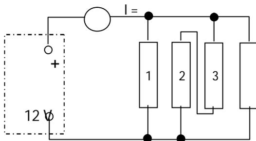
Rangkailah tahanan-tahanan tersebut pada baterai agar aliran arus dan besar tegangan sesuai dengan yang dibutuhkan.
