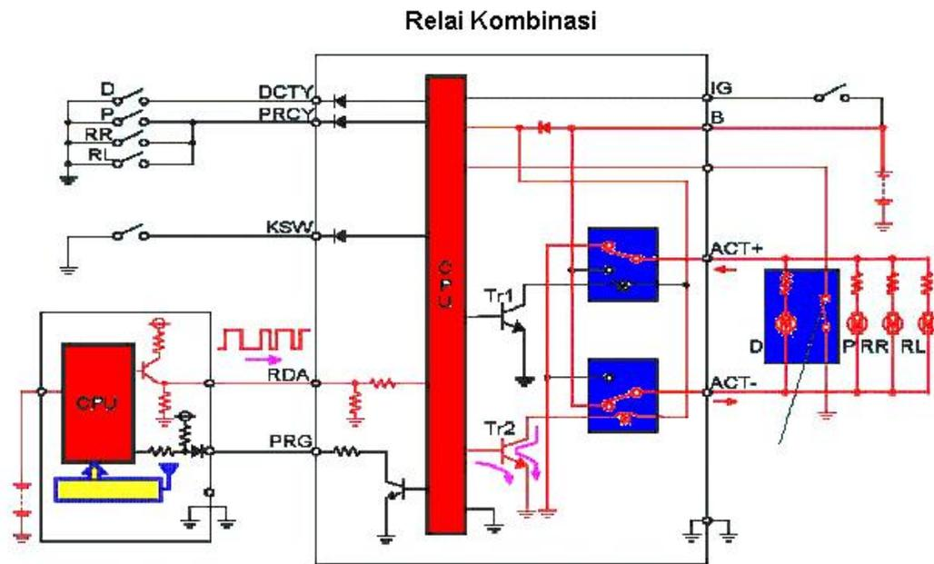
Gambar 8. 14. Operasi buka dengan remote
