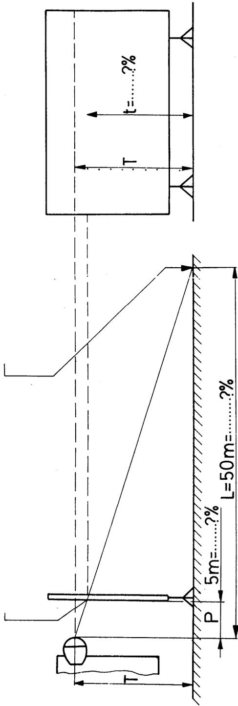
Keterangan : P = Jarak papan penyetel dengan lampu
