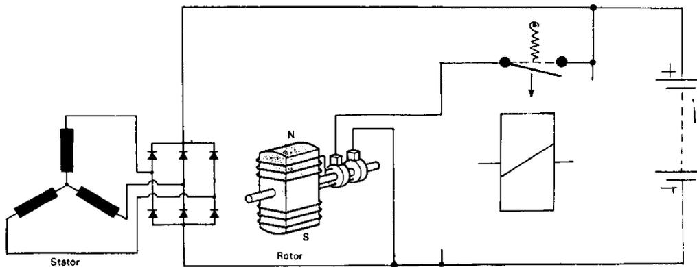
Gambar 5.28. Konstruksi regulator 1 kontak
