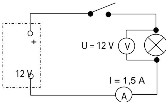
Skema ini merupakan rangkaian lampu yang diukur dengan Voltmeter dan
