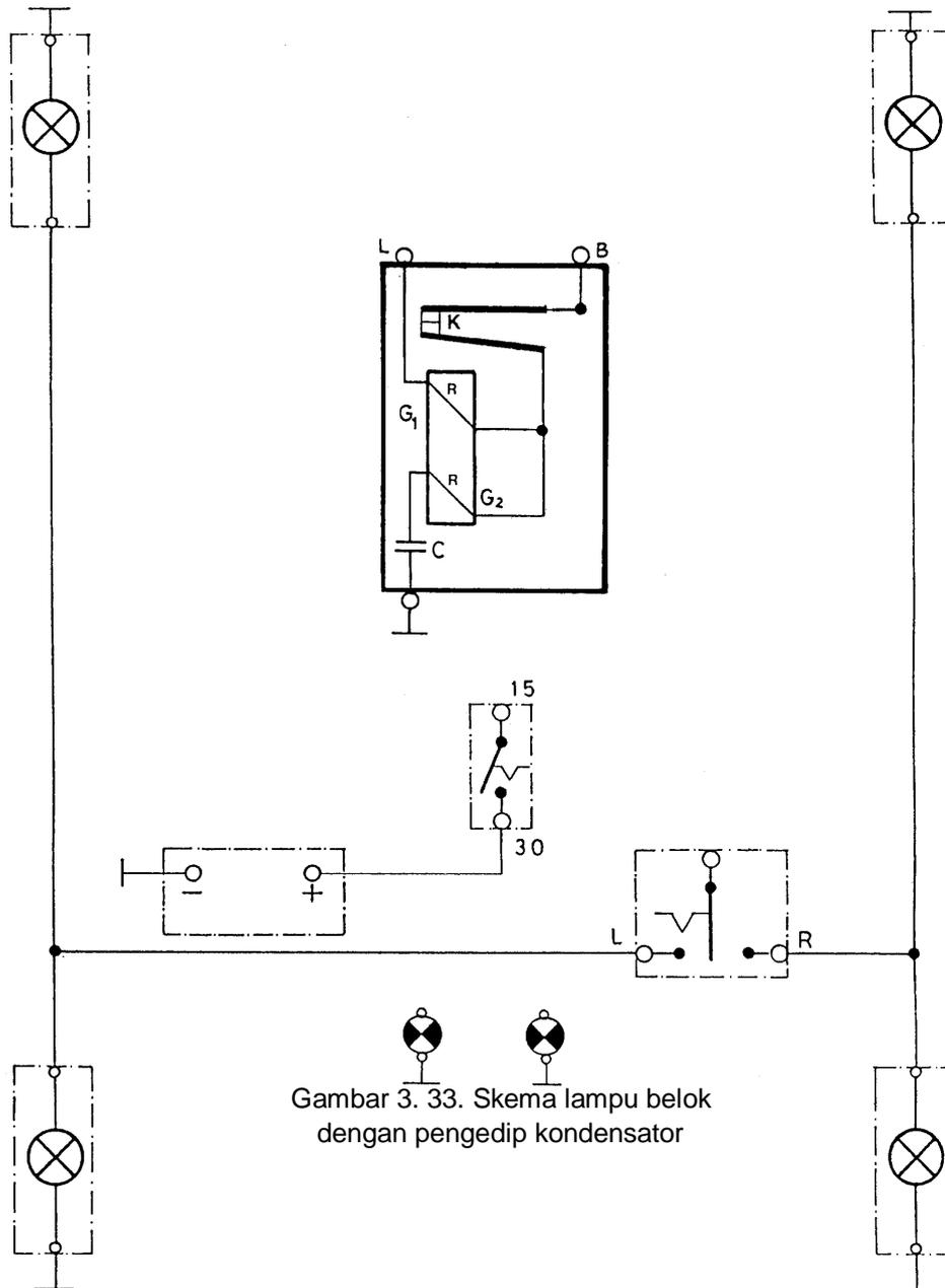
Gambar 3. 33. Skema lampu belok dengan pengedip kondensator
