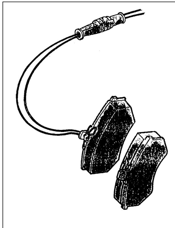
Gambar 3. 57. Skema kontrol keausan kampas rem
