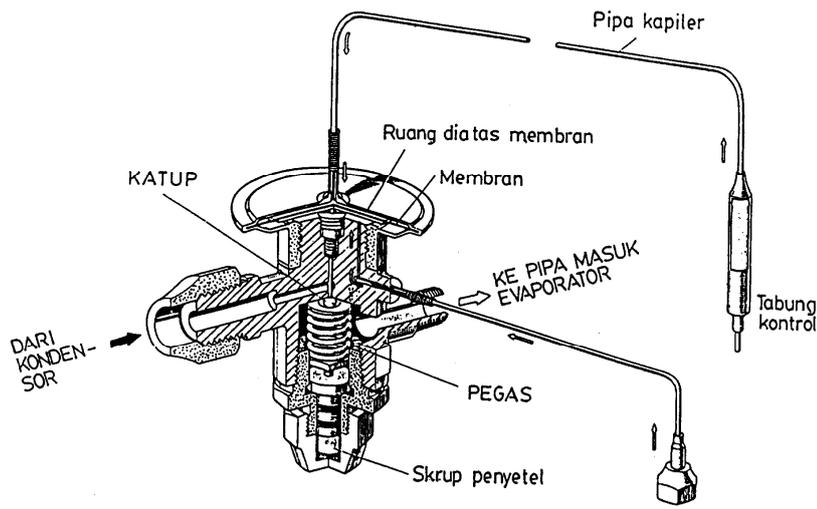
Gambar 7. 35. Katup ekspansi dengan kontrol tekanan dan temperatur
