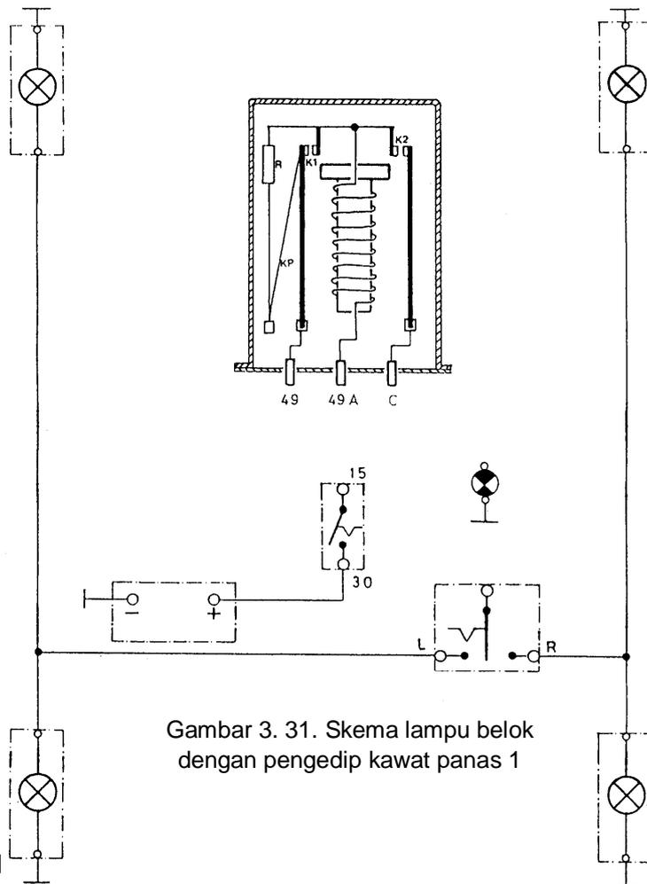
Gambar 3. 31. Skema lampu belok dengan pengedip kawat panas 1
