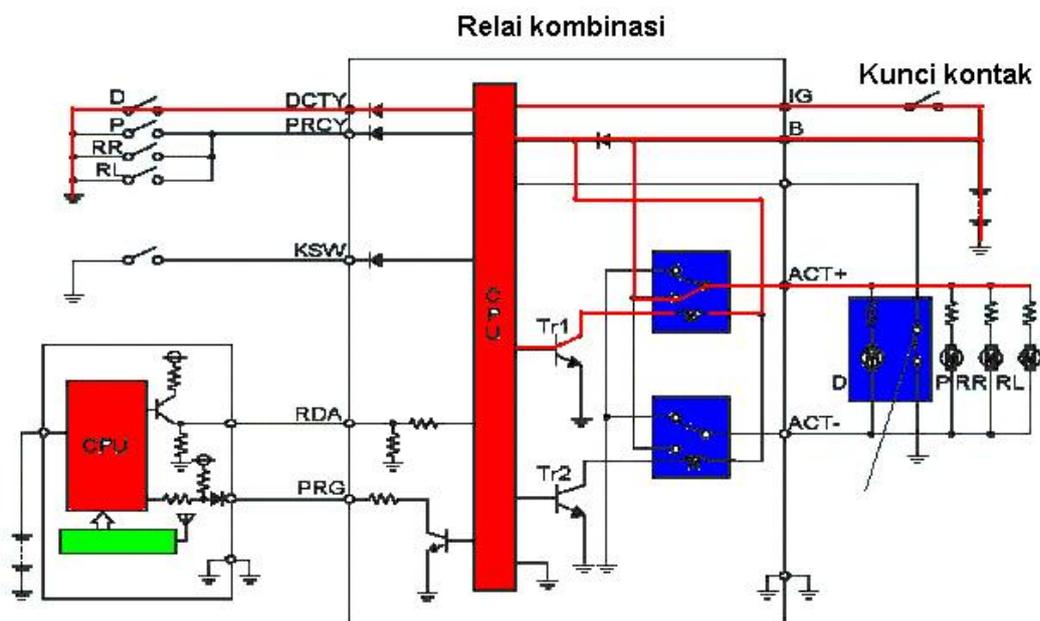
Gambar 8. 11. Operasi buka tutup secara manual
