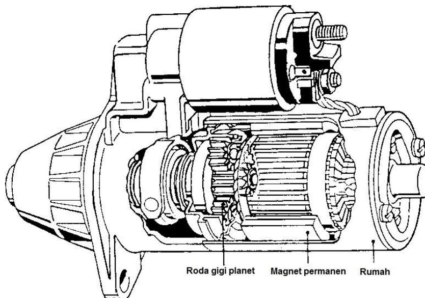
Gambar 6. 19. Stater dorong skrup dengan magnet permanen
