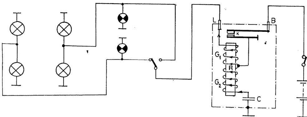
Posisi lampu mati ; kontak membuka, kondensator mengosongkan
