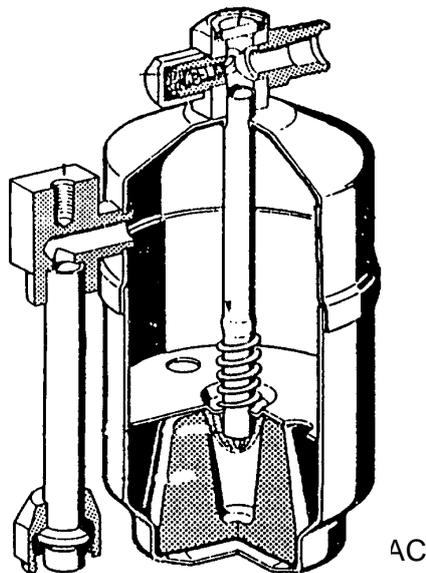
Uap air adalah gangguan yang paling utama dalam sistem AC, karena uap air menyebabkan terjadi *pembekuan (es)* pada saluran-saluran dalam sistem, terutama pada *katub ekspansi* mengakibatkan sistem AC tidak berfungsi dengan baik.
