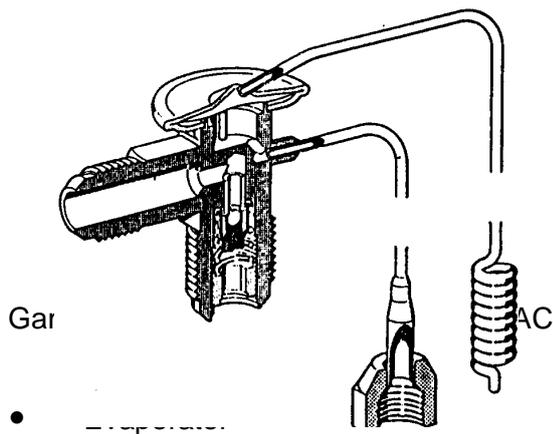
Zat pendingin yang sudah dikondensasi oleh *kondensor* tekanannya harus diturunkan oleh *katub ekspansi* supaya zat pendingin dapat menyerap panas di sekeliling evaporator. Katup ekspansi ini dipasangkan pada saluran masuk evaporator ( menjadi satu unit ).
