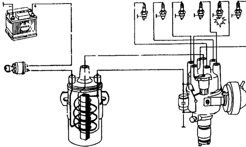
Gambar 4.3. Skema sistem pengapian batterai
