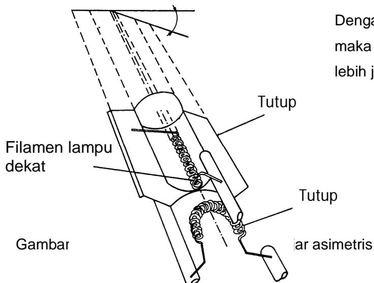
Dengan membentuk sudut  $15^\circ$  pada sendok maka akan dicapai suatu penerangan yang lebih jauh dibagian tepi jalur jalan bagian kiri
