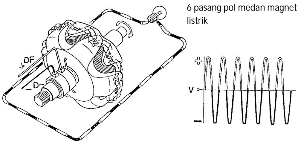
Gambar 5.11. Rotor dengan 6 pasang pool magnet listrik
