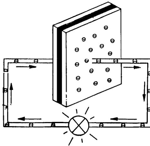
Gambar 4.29. Pelepasan muatan kondensator
