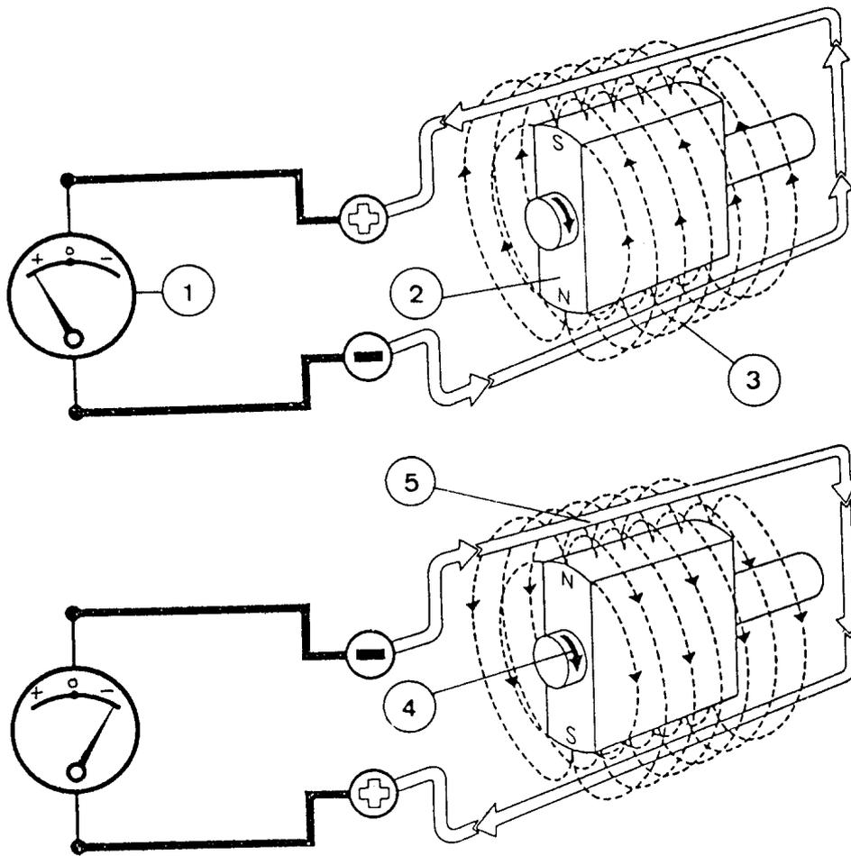
Gambar 5.7. Prinsip pembangkit tegangan
