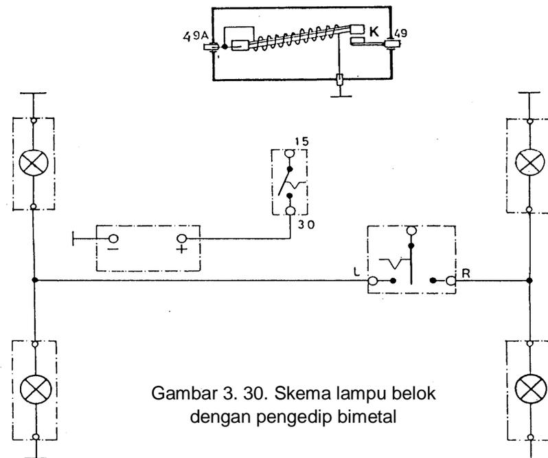
Gambar 3. 30. Skema lampu belok dengan pengedip bimetal
