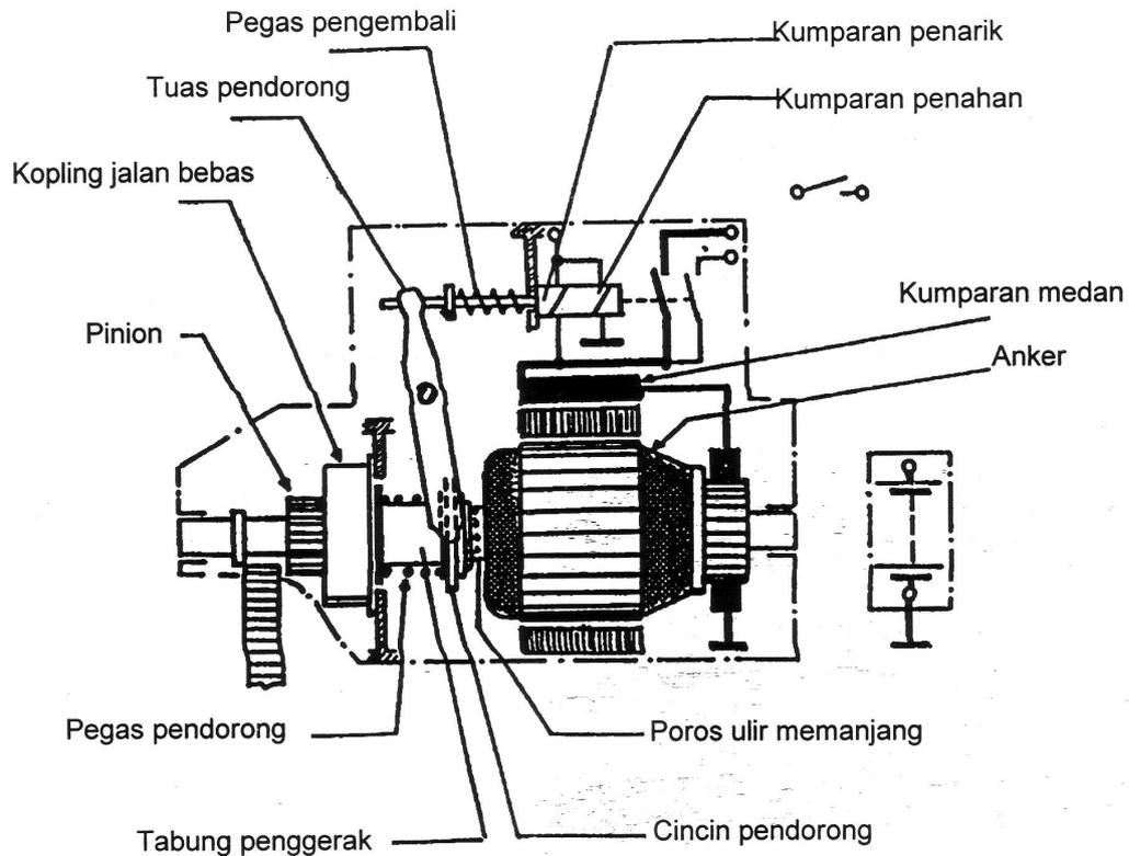
Gambar 6. 12. Skema konstruksi starter dorog dan sekrup
