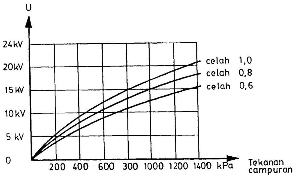
Gambar 4.45. Grafik pengaruh celah elektroda busi terhadap tegangan
