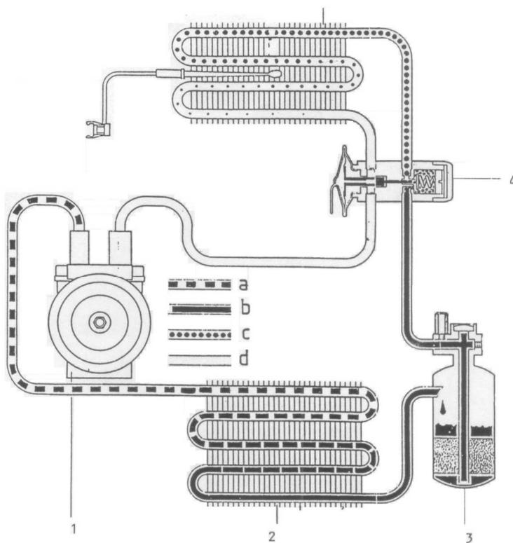
Gambar 7. 1. Skema sistem AC
