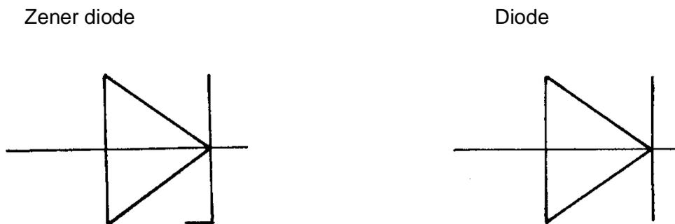
Gambar 5.32. Dioda Zener dan Dioda
