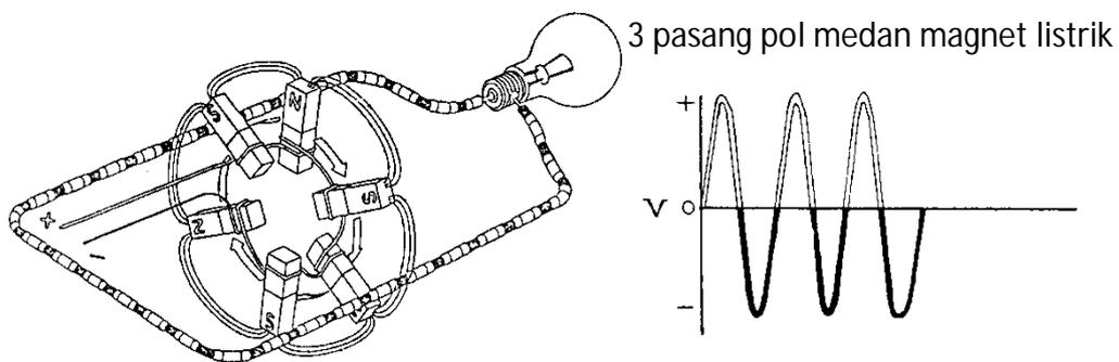
Gambar 5.10. Rotor dengan 3 pasang pool magnet listrik
