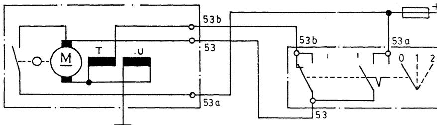
Gambar 3. 25. Wiper 2 kecepatan dengan magnet listrik
