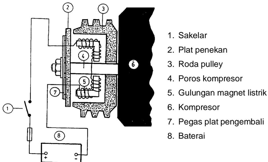
Gambar 7. 24. Konstruksi kopling magnet
