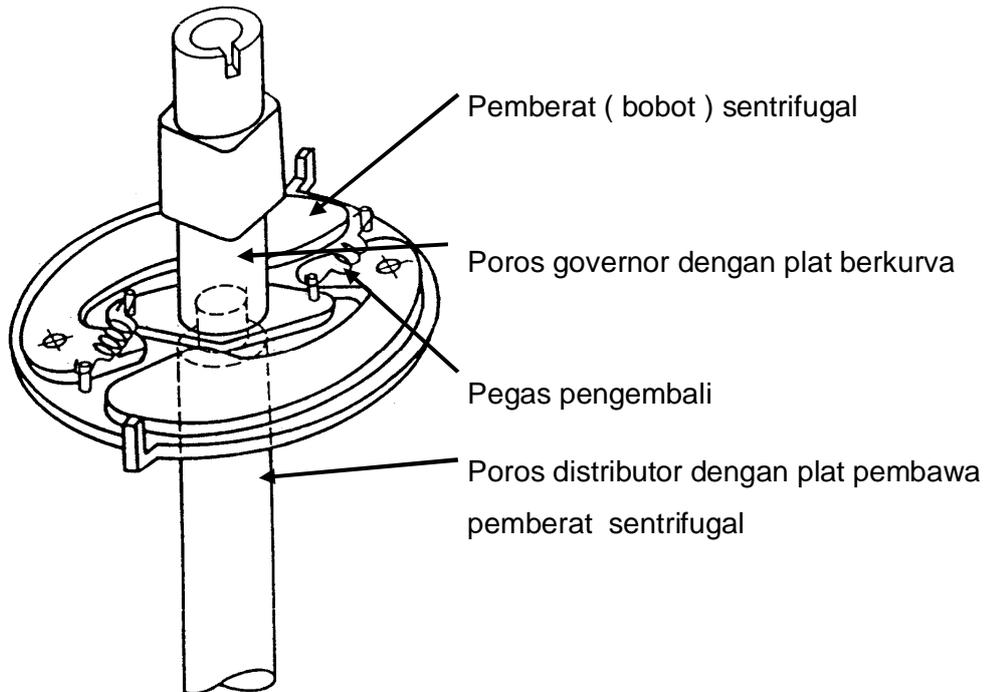
Gambar 4.53. Konstruksi advance sentrifugal
