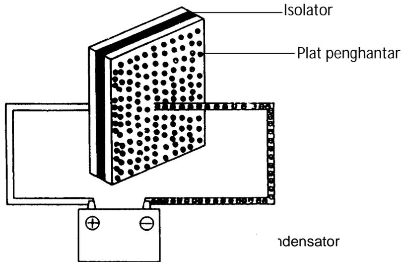
Jika sumber tegangan dilepas, elektron-elektron masih tetap tersimpan pada plat kondensator \* ada penyimpanan muatan listrik
