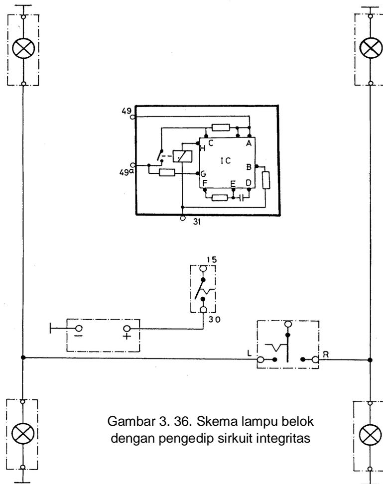
Gambar 3. 36. Skema lampu belok dengan pengedip sirkuit integritas
