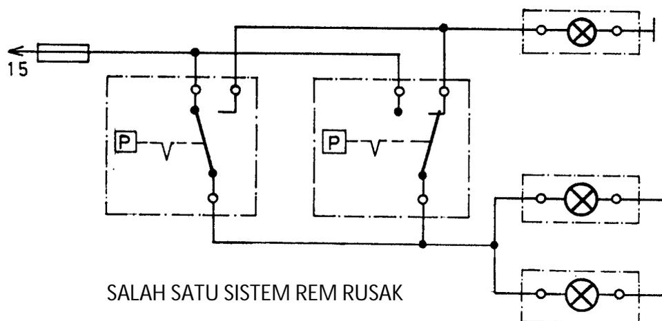
Gambar 3. 56. Skema kontrol rem posisi salah satu rusak
