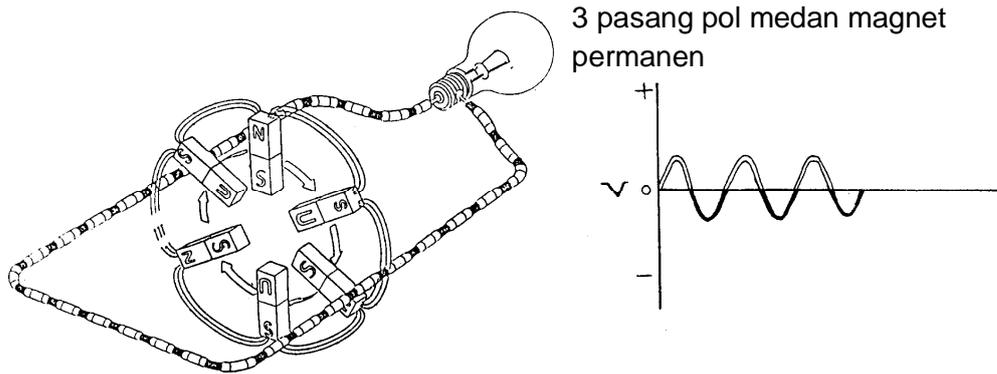
Gambar 5.9. Rotor dengan 3 pasang pool magnet permanen
