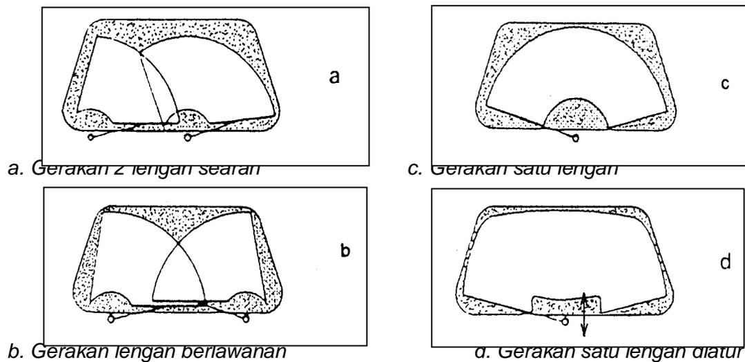
Gambar 3. 21. Macam macam konstruksi lengan penghapus kaca
