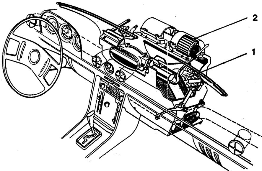
Gambar 7. 13. Evaporator dan Blower terpasang pada kendaraan
