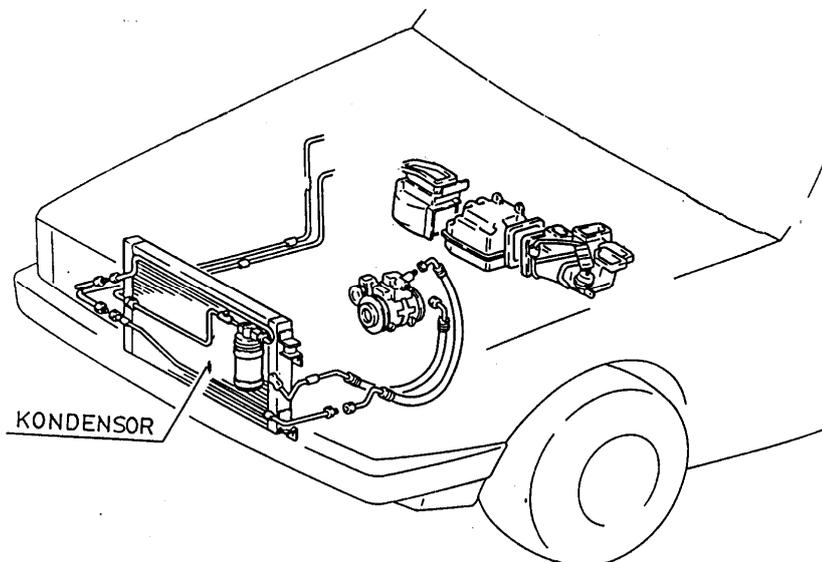
Gambar 7. 26. Kondensor terpasang dibagian depan mobil
