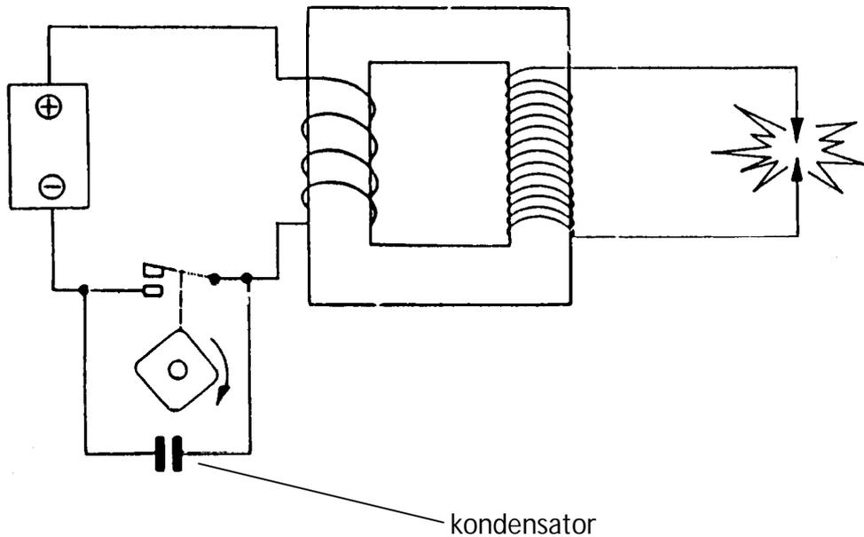
Gambar 4.26. Penambahan kondensator untuk menghilangkan efek induksi diri
