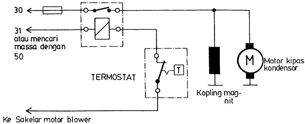
Gambar 7. 37. Skema kelistrikan kopling magnet dan motor blower
