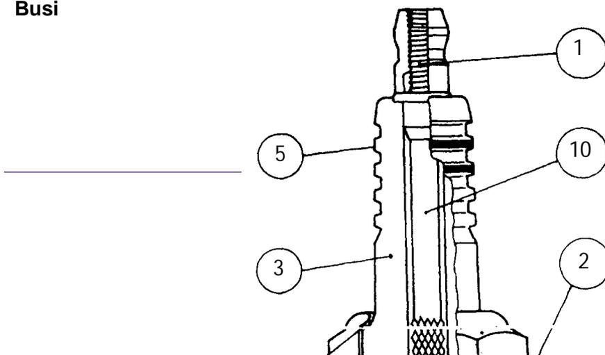
Gambar 4.39. Konstruksi Busi
