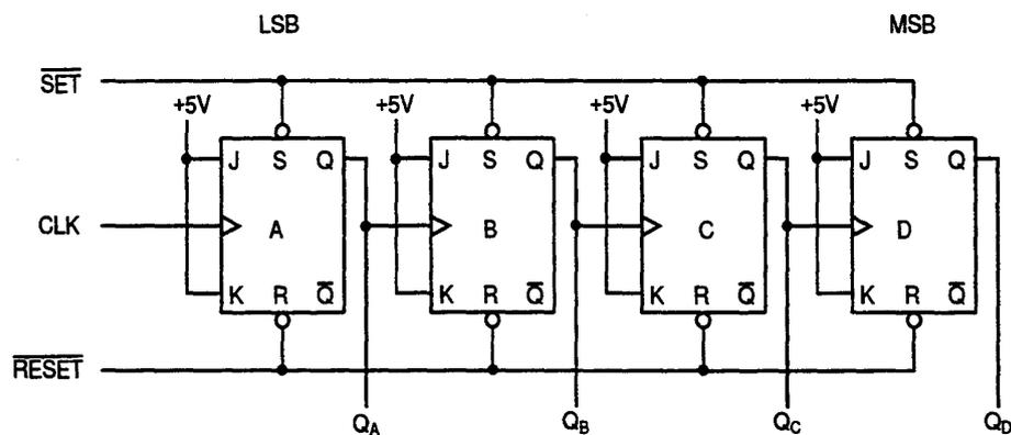
Gambar 1.39 Penghitung Turun Ripple
