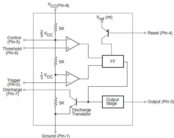
**Gambar 1.29 Skematik Internal dari Timer IC 555**
