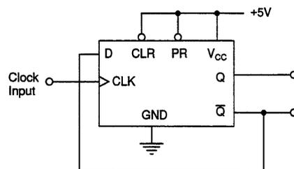
Gambar 1.32 D Flip-flop sebagai rangkaian pembagi 2
