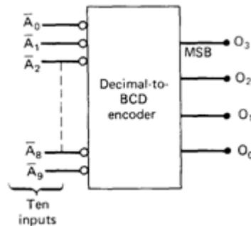
**Gambar 1.22** Enkoder Desimal ke BCD
