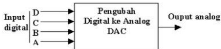
**Gambar 1.50** Pengubah digital ke analog (DAC) 4 bit
