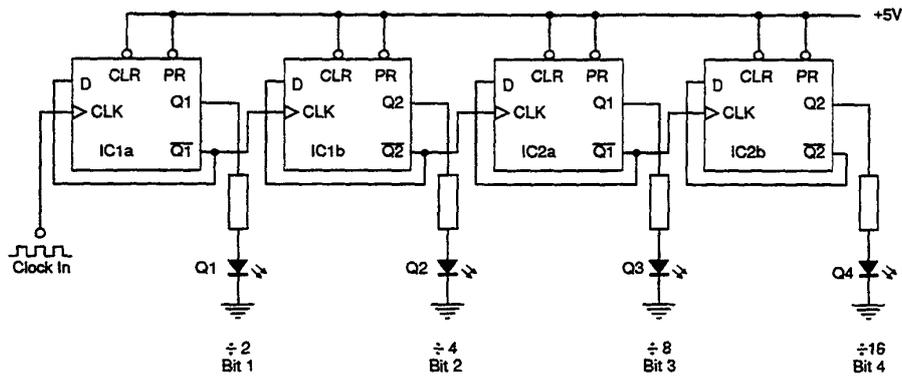
Gambar 1.34 Penghitung Biner Menggunakan D-FF
