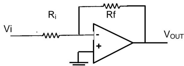
Jika dari gambar diatas diketahui  $V_{in} = 3$  Volt,  $R_f = 20$  K $\Omega$ ,  $R_i = 150$  K $\Omega$ , hitunglah berapa penguatannya!  $A = R_f/R_i$   $A = 20$  K $\Omega$ /150 K $\Omega$  = 0,133
