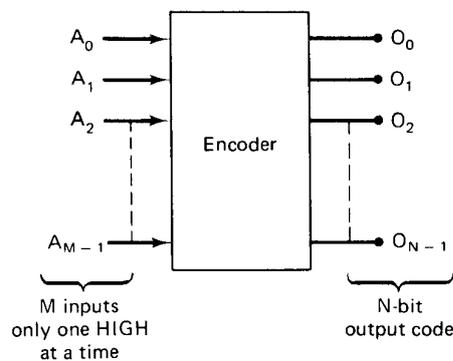
**Gambar 1.20 Diagram Enkoder**
