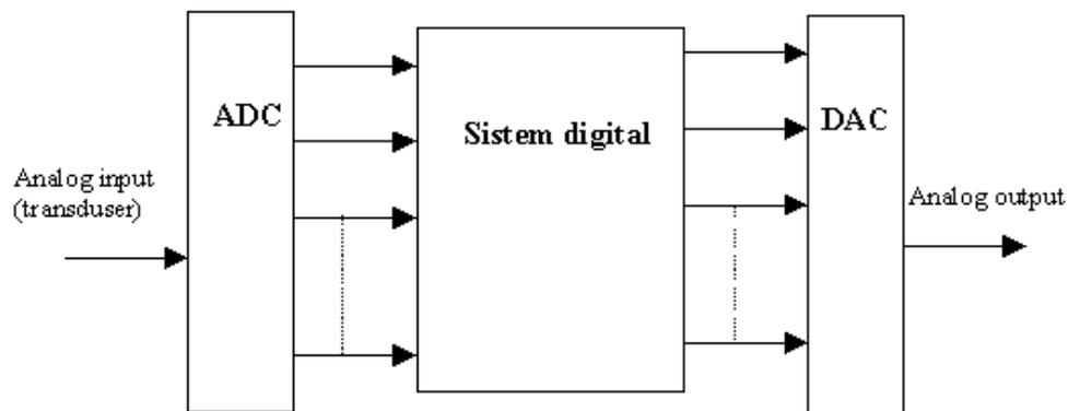
**Gambar 1.46** Sirkit kendali digital menggunakan rangkaian ADC dan DAC
