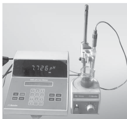
Gambar 3.4 pH-meter dapat mendeteksi pH larutan secara akurat
