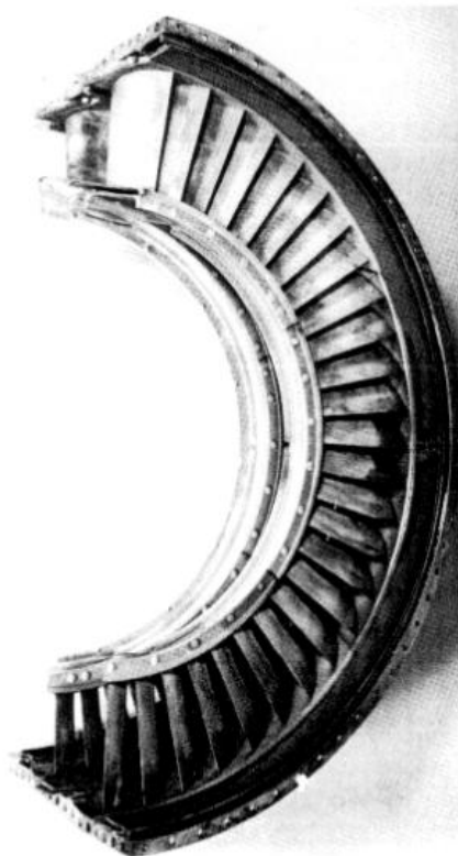
Gambar 2.125 Bentuk dari sudu jalan turbin
