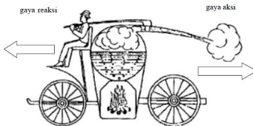
Gambar 2.86 Mesin uap Newton gaya aksi reaksi
