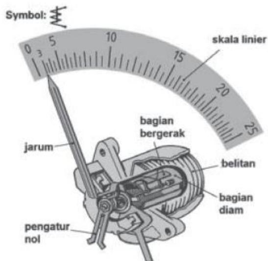
Gambar 6.12 Konstruksi Besi Putar Tipe Repulsi
