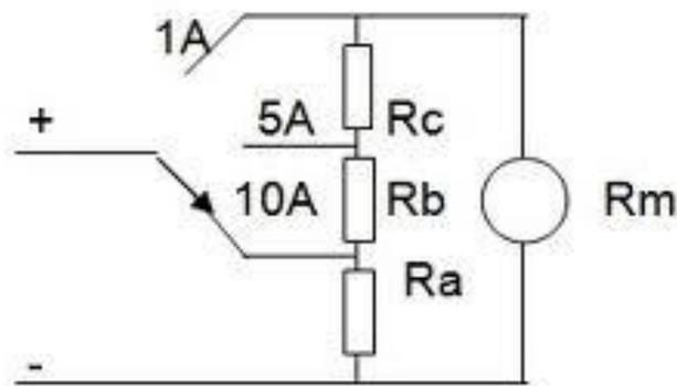
Gambar 6.19 Tahanan Shunt untuk Multi Batas Ukur
