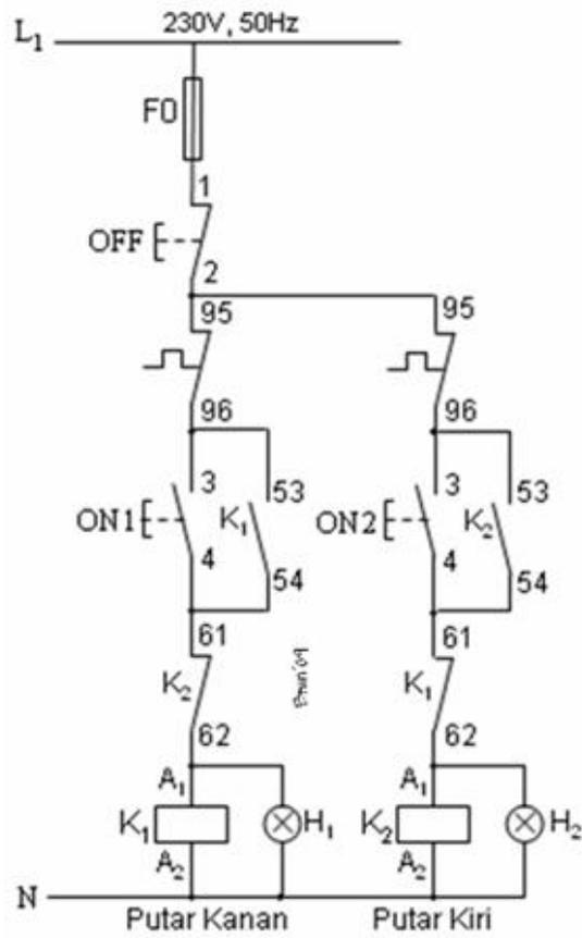
Gambar 3.30 Aplikasi Rangkaian Kombinasi pada Sirkit Kontrol Motor
