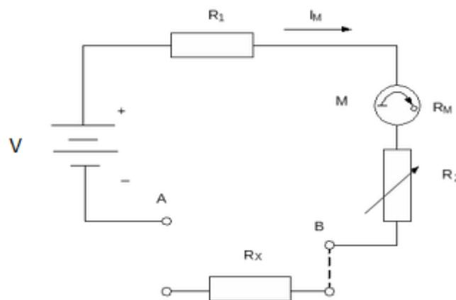
Gambar 8.4 Rangkaian Dasar Ohmmeter Seri
