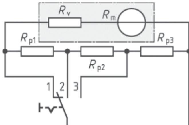
Gambar 6.22 Ampermeter dengan Tiga Batas Ukur Sistem Airtone
