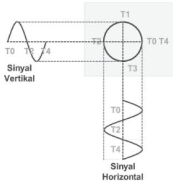
Gambar 9.9 Beda Fasa  $90^\circ$  atau  $270^\circ$  antara Input dan Output
