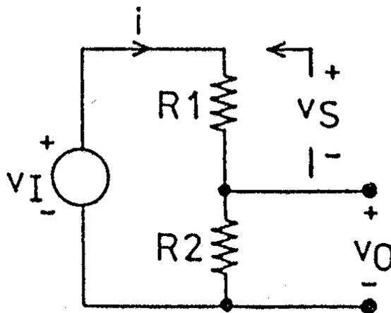
Gambar 3.28 Rangkaian Pembagi Tegangan
