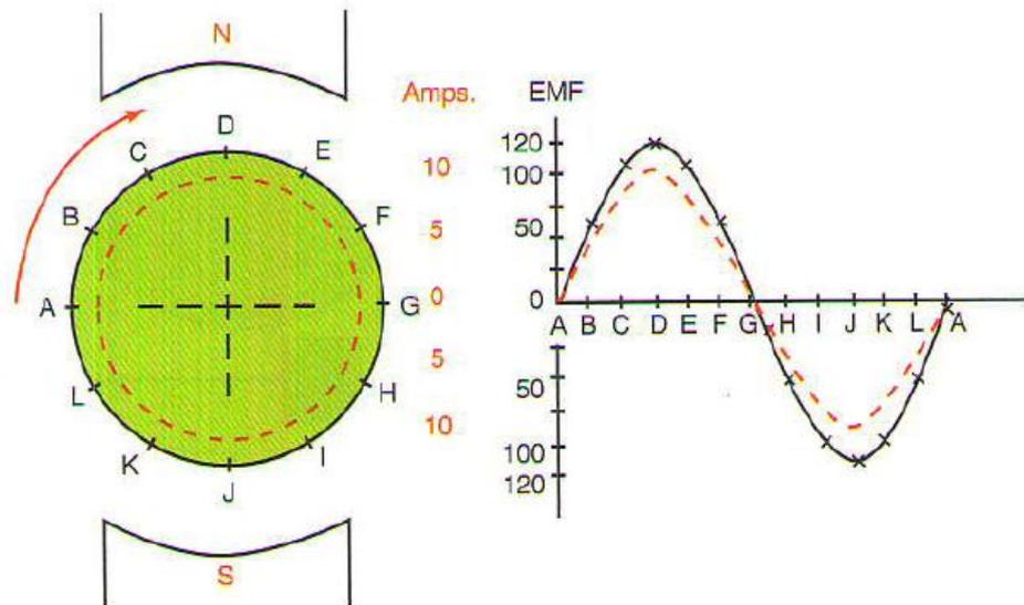
Gambar 1.23 Arus dan tegangan (emf) berubah dalam satu putaran Jangkar
