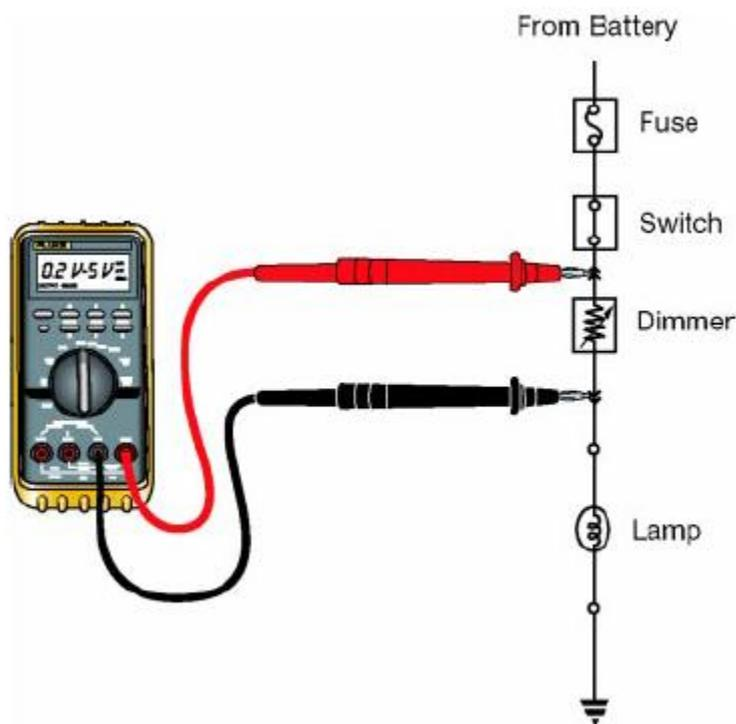
Gambar 6.31 Pengukuran Tegangan pada Rangkaian Listrik
