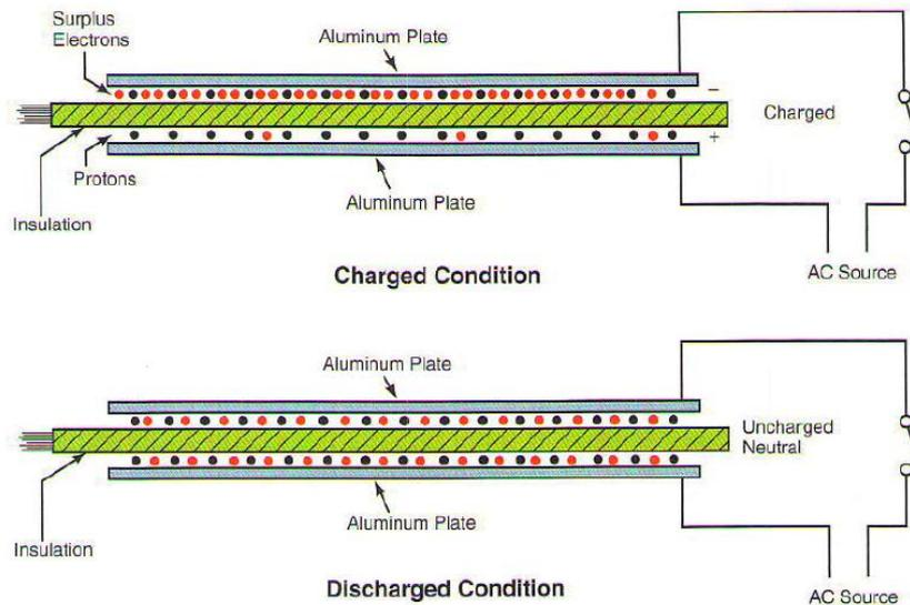
Gambar 3.8 Konstruksi Kapasitor
