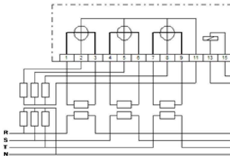
Gambar 7.17 Pengawatan kWh-meter Tiga Fasa, 4 kawat
