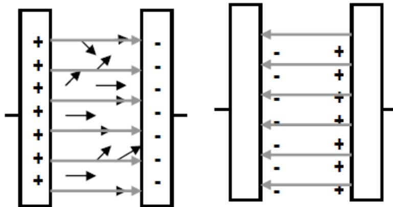
Gambar 3.9 Plat Paralel sesudah terhubung dengan Sumber Tegangan
