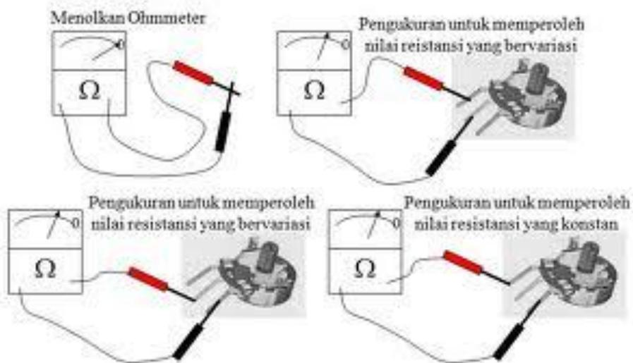
Gambar 8.6 Prinsip Pengukuran Tahanan dengan Ohmmeter Seri
