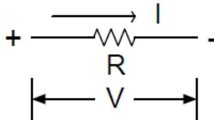
Gambar 3.34 Turun Tegangan pada Resistor
