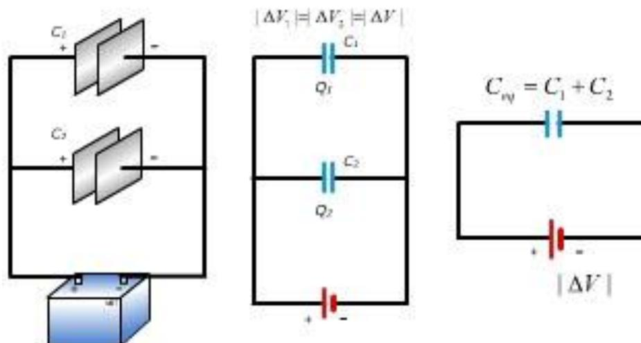
Gambar 3.19 Rangkaian Paralel Kapasitor
