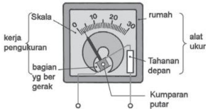
Gambar 6.3 Konstruksi Alat Ukur Analog
