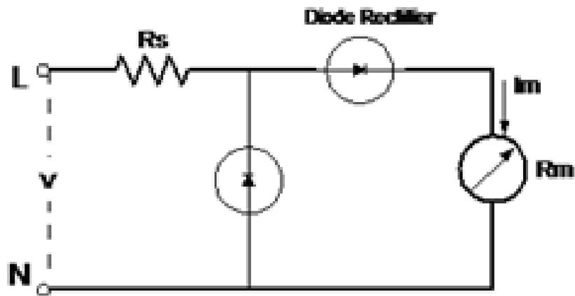
Gambar 6.28 Skematik Voltmeter Arus Bolak-Balik
