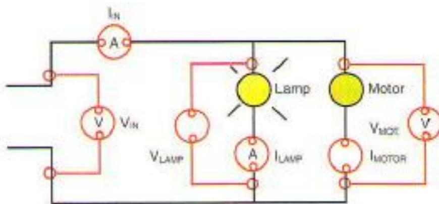
Gambar 3.24 Rangkaian Listrik Secara Paralel
