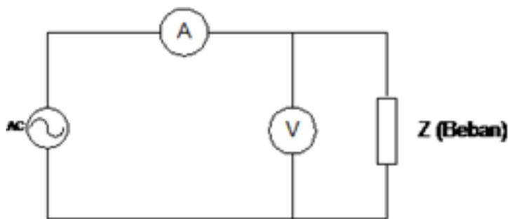
Gambar 7.2 Rangkaian Pengukuran Daya Semu ( $S$ ) Langsung
