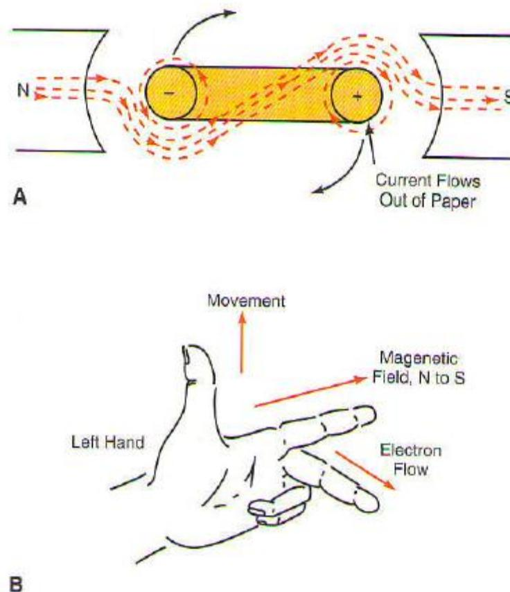
Gambar 6.6 Prinsip Pembangkitan Torsi Pada Motor DC
