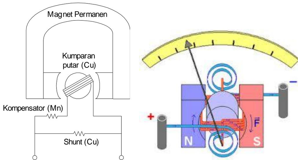
Gambar 6.7 Gambar skematik meter PPMC ( D'Arsonval)
