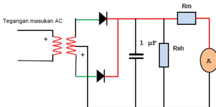
Gambar 6.23 Prinsip Ampermeter Arus Bolak-balik
