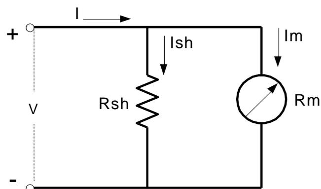
Gambar 6.18 Rangkaian Dasar ampermeter DC
