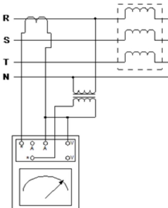
Gambar 7.11 Pengukuran Daya Tiga Fasa dengan Satu Wattmeter secara Tidak Langsung
