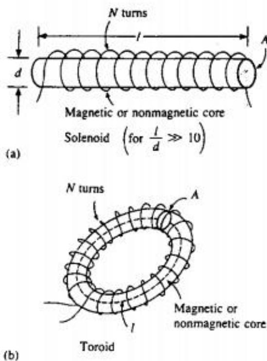
Gambar 3.7 Konstruksi Induktor
