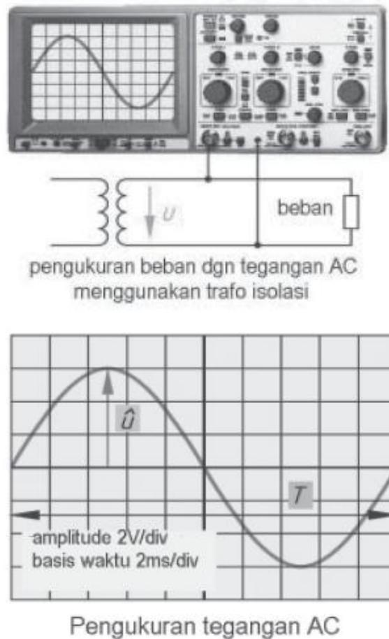
Gambar 9.4 Cara Pengukuran Tegangan AC
