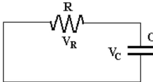
Apabila sumber dilepas dan rangkaian RC dihubung-singkat (seperti pada gambar di atas), maka kapasitor akan melepaskan muatannya.
