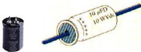
Gambar 3.15 Kapasitor Elektrolit
