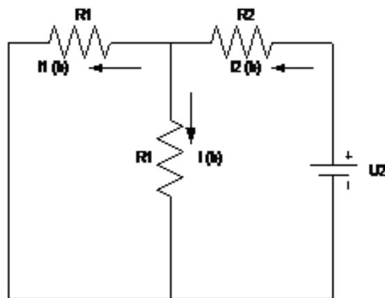
Pada langkah satu tegangan U2 dihubung singkat, kemudian arus pada setiap cabang rangkaian dihitung.
