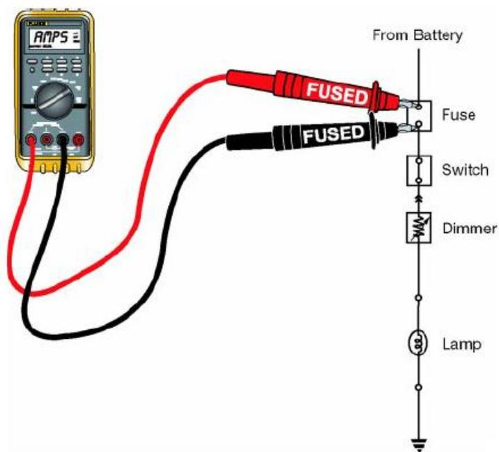
Gambar 6.17 Prinsip Pengukuran Arus pada Rangkaian Listrik
