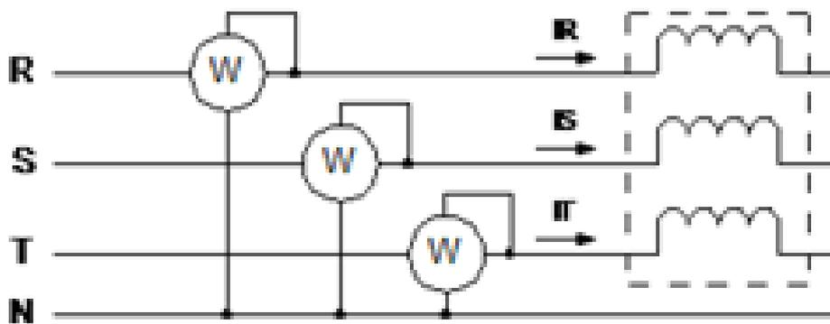
Gambar 7.9 Pengukuran Daya Tiga Fasa dengan Tiga Wattmeter
