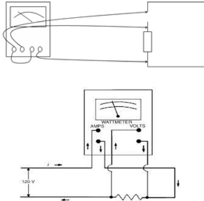
Gambar 7.5 Rangkaian Pengukuran Daya Aktif dengan Wattmeter
