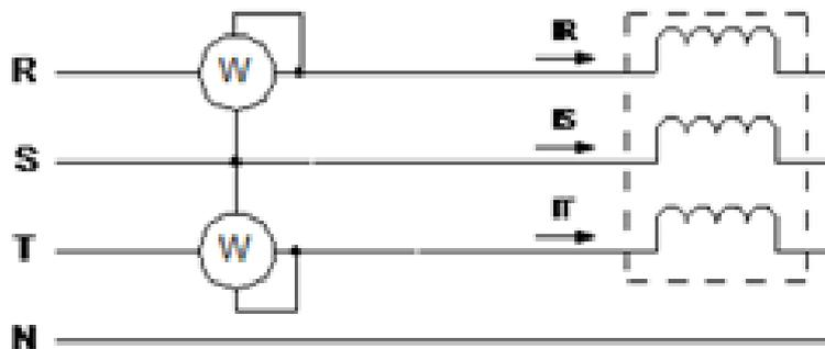
Gambar 7.10 Pengukuran Daya Tiga Fasa dengan Dua Wattmeter
