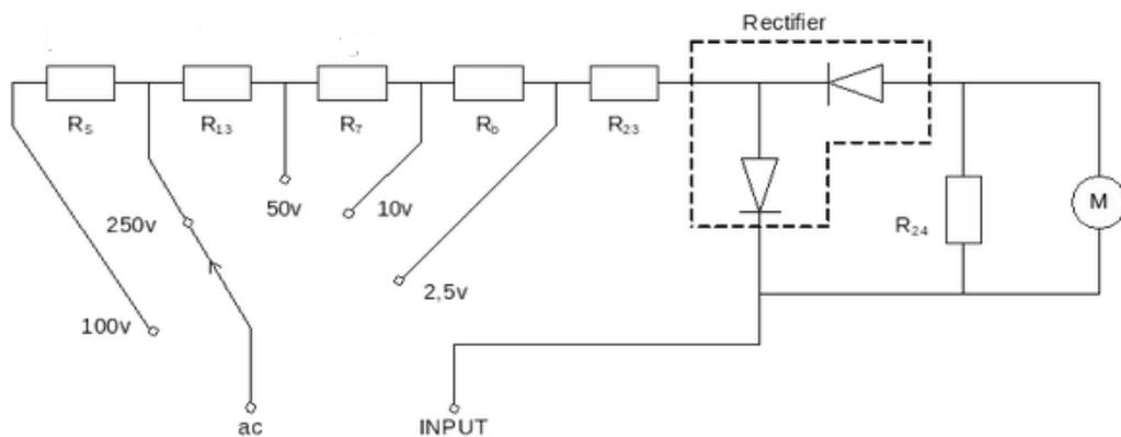
Gambar 6.30 Rangkaian Dasar Voltmeter Arus Bolak-balik
