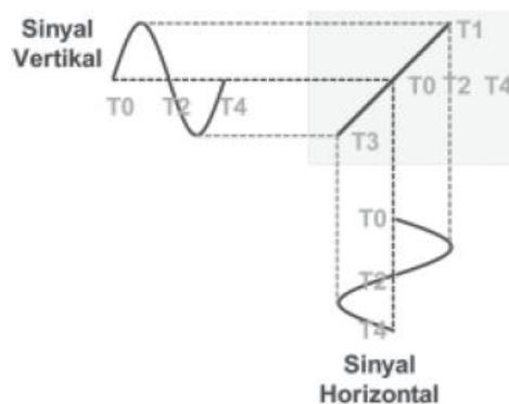
Gambar 9.8 Beda Fasa nol atau  $360^\circ$  antara Input dan Output
