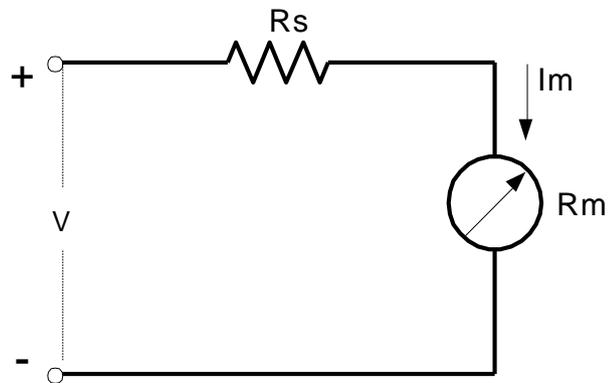
Gambar 6.25 Rangkaian Dasar Voltmeter Arus searah
