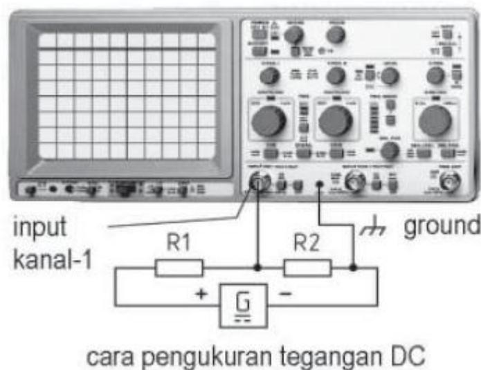
Gambar 9.3 Cara Pengukuran Tegangan DC
