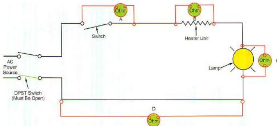
Gambar 8.2 Koneksi Ohmmeter untuk mengukur Resistan
