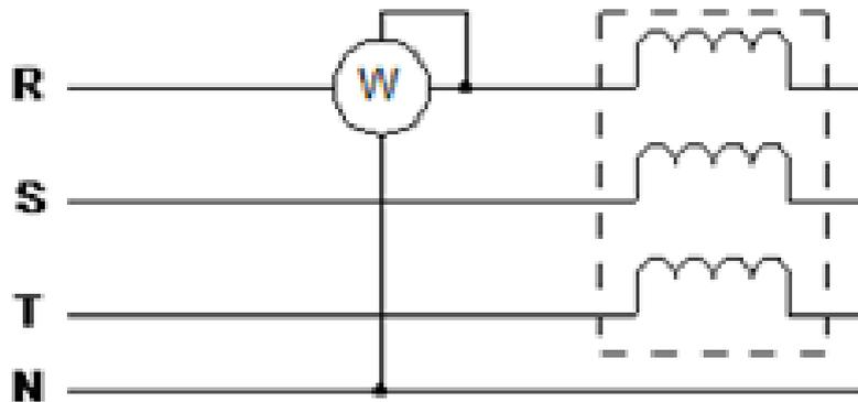
Gambar 7.8 Pengukuran Daya Tiga Fasa dengan Satu Wattmeter
