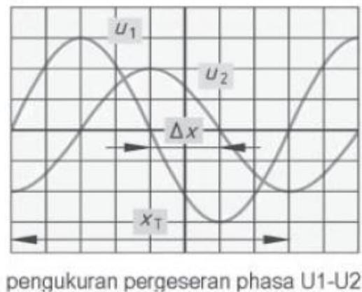
Gambar 9.6 Pengukuran Beda Fasa
