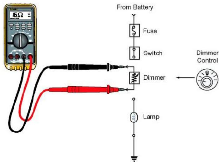
Gambar 8.7 Pengukuran Tahanan pada suatu Rangkaian Dimer
