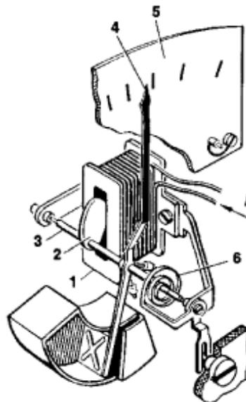
Gambar 6.10 Konstruksi Meter Besi Putar tipe Induksi
