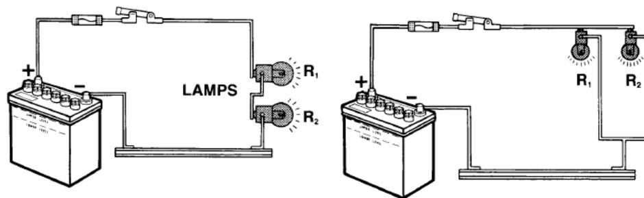
**Gambar 5.1 Lampu dalam Hubungan Seri dan Paralel**
