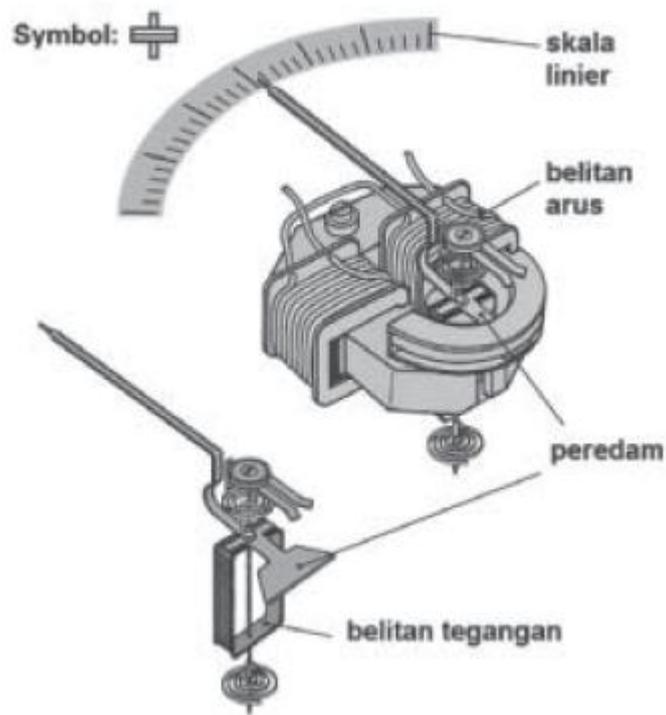
Gambar 7.4 Konstruksi Elektrodinamis
