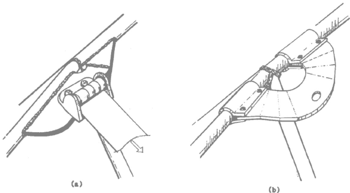
Gbr.22 Pemasangan dan penguatan pada struktur pipa yang dilas
