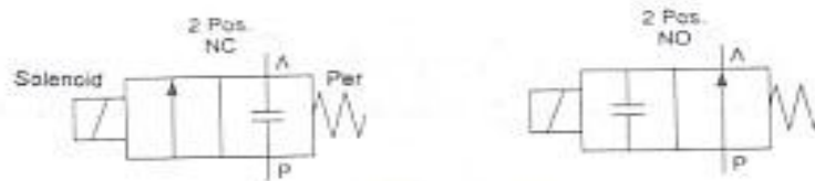
(c) Klep 2/2-jalan yang dioperasikan dengan solenoid
