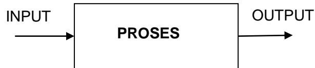
(a) Sistem Kontrol Lingkar Terbuka
