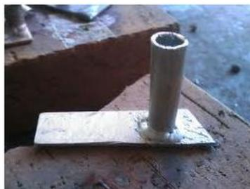
1. Bersihkanlah permukaan plat dan ujung bagian pipa yang akan disambung dari kotoran baik itu oli dan kotoran lainnya dengan menggunakan kertas ampelas dan kain kering.
