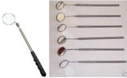
halnya pada pemeriksaan bagian-bagian komponen mesin pendingin. Untuk memeriksa hasil pengelasan atau mencari kebocoran pada tempat yang sukar dilihat. Alat ini ada yang dilengkapi lampu baterai sehingga bisa memeriksa bagian yang
