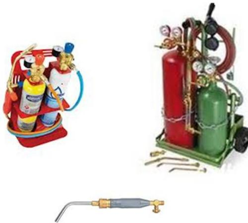
**Gambar 3.44. Kelengkapan las/brasing**
