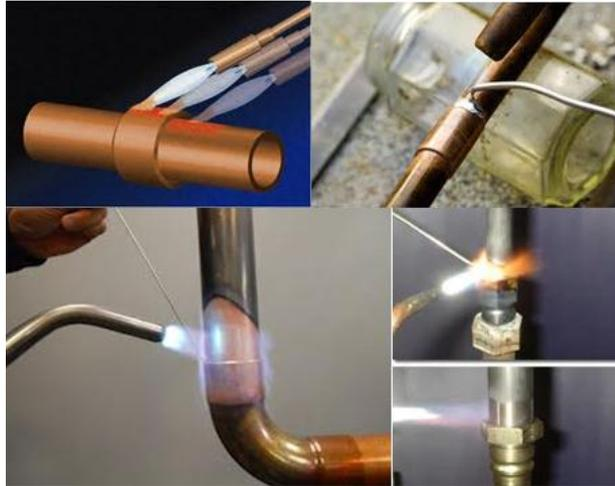
**Gambar 3.64 Pengelasan pipa**
