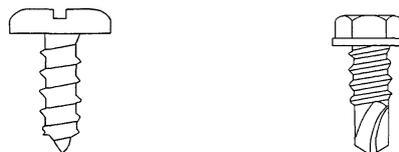
**Gambar 2.68 *Self Tapping* dan *Self Drilling***
