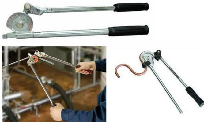
**Gambar 3.53 Membengkok pipa dengan *lever bender***
