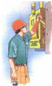
**Gambar 4.39 Titik pemutusan aliran listrik**
