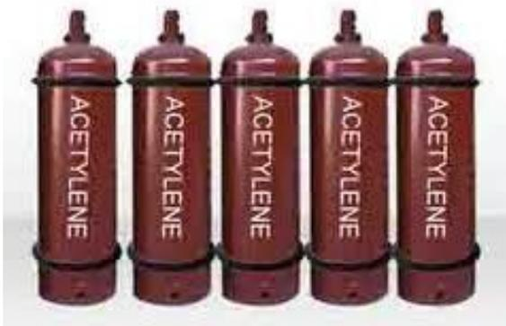
Gas asetilena dimampatkan ke dalam silinder baja dengan volume 40 liter dan tekanan 15 bar. Silinder asetilena diisi dengan bahan berpori-pori, seperti kapas, sutra tiruan, atau asbes yang berfungsi sebagai penyerap asetilena.
