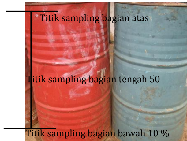
Gambar 2. Cara menentukan titik pengambilan contoh bahan cairan
