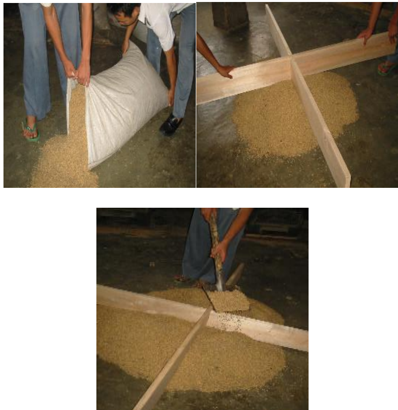
Gambar 12. Mengumpulkan Contoh, Membagi, dan Mencampur Contoh
