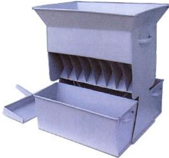
**Gambar 17. Riffle Divider**
