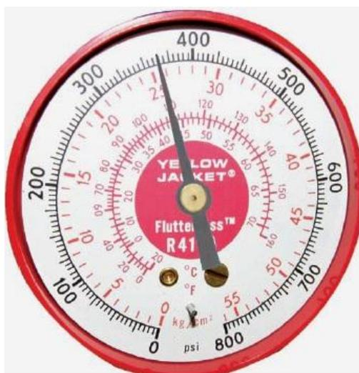
Gambar 4.4 Tipikal Skala pada *Gauge Manifold*
