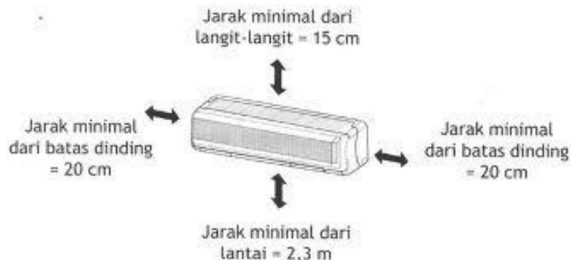
Gambar 6.3 Aturan Penempatan Unit Indoor
