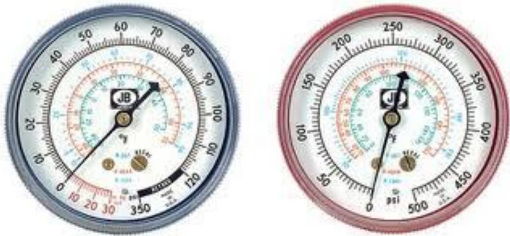
**Gambar 4.5 Skala Suhu pada LPG dan HPG**
