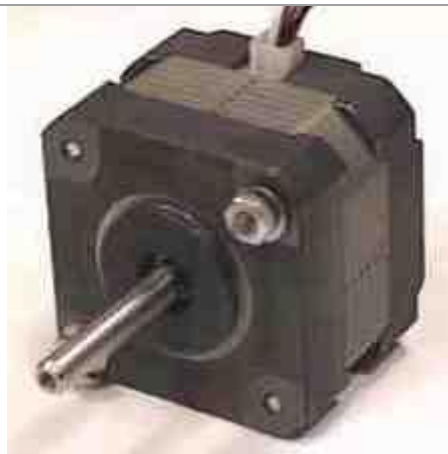
Gambar 61 Bentuk fisik motor stepper disk drive 1,2"
