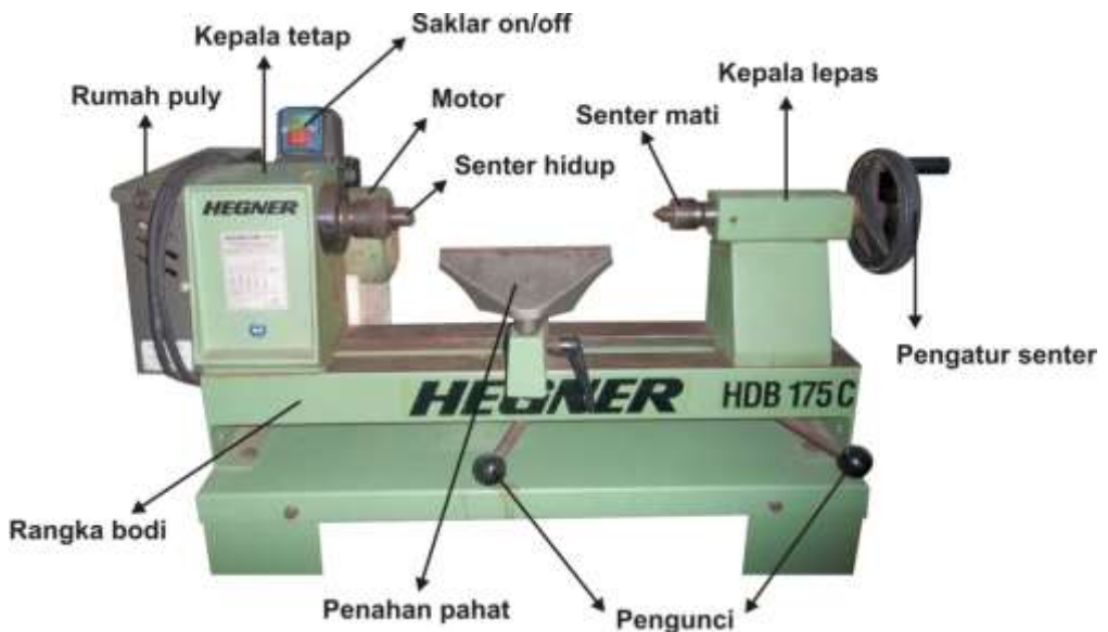
(Gambar 1-8. bagian-bagian mesin bubut) Sumber. Dok. Studio kayu
