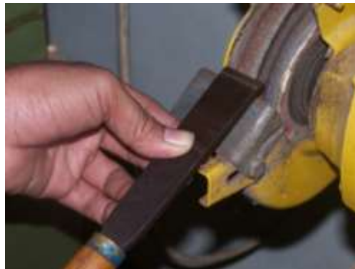
(Gambar 3-16. Mengasah pahat lurus menggunakan mesin gerinda) Sumber dok. Studio Kayu
