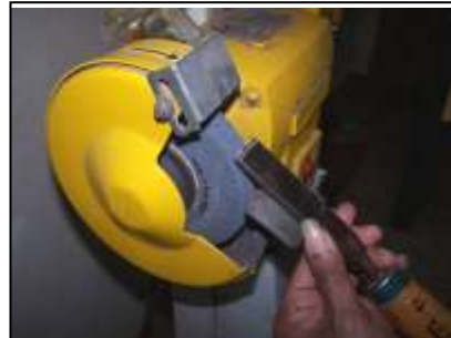
(Gambar 3-15. Mengasah pahat bubut menggunakan mesin gerinda) Sumber dok. Studio Kayu
