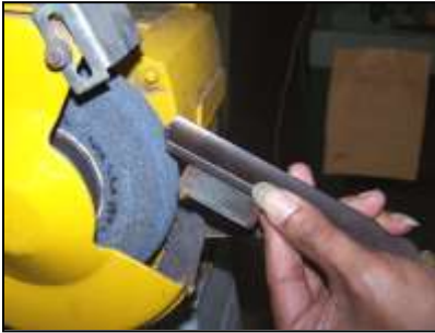
(Gambar 3-15. Mengasah pahat bubut menggunakan mesin gerinda) Sumber dok. Studio Kayu
