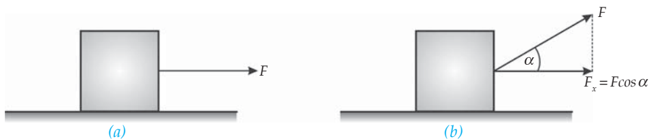
Gambar 4.8 (a) Balok pada bidang datar licin ditarik horizontal (b) Balok pada bidang datar licin ditarik dengan membentuk sudut \alpha .
