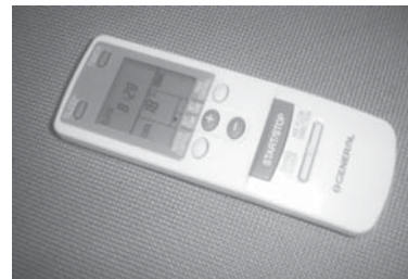
Gambar 8.6 Remote kontrol menggunakan sinar infra merah.
