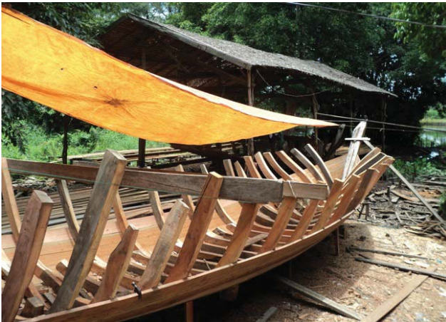
Gading-gading dan papan lambung yang sebagian sudah terpasang
