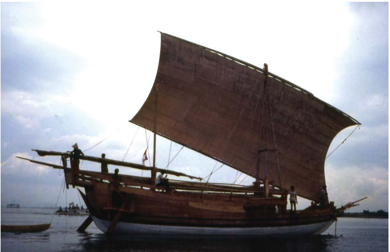
Perahu pa'dewakang merupakan perahu awal dari perahu pinisi. Perahu jenis ini sudah hamper punah, tidak diproduksi lagi karena dianggap kurang laju dalam melakukan pelayaran.
