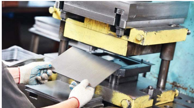
Gambar 6. Operasi logam lembaran dikerjakan dengan mesin kempa (press)
